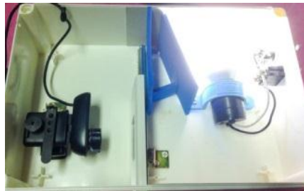
ภาพที่ 3 ภาพการประกอบกล่องแปลภาพรังสีทันตกรรมดิจิทัลประดิษฐ์ และการทดสอบการทำงาน
