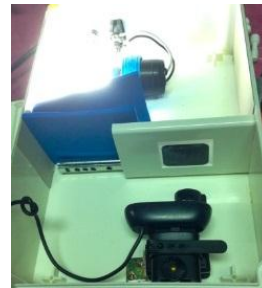
ภาพที่ 3 ภาพการประกอบกล่องแปลภาพรังสีทันตกรรมดิจิทัลประดิษฐ์ และการทดสอบการทำงาน
