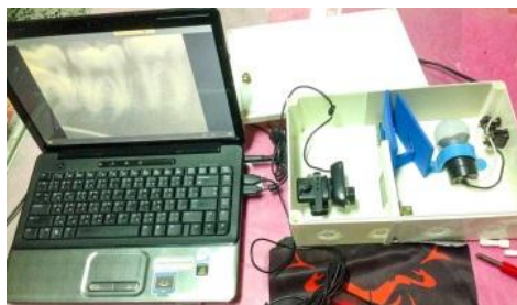
ภาพที่ 4 ภาพการทดสอบการทำงานเชื่อมต่อกับระบบคอมพิวเตอร์ที่มีซอฟต์แวร์ ซึ่งเป็นส่วนแสดงผลภาพถ่ายรังสีทันตกรรม
